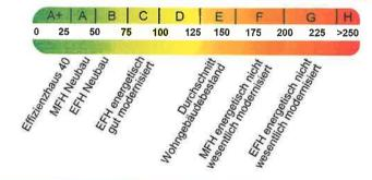
modellhaft ermittelten Vergleichswerte beziehen sich auf Gebäude, in denen Wärme für Heizung und Warmwasser durch Heizkessel im Gebäude bereitgestellt wird.
